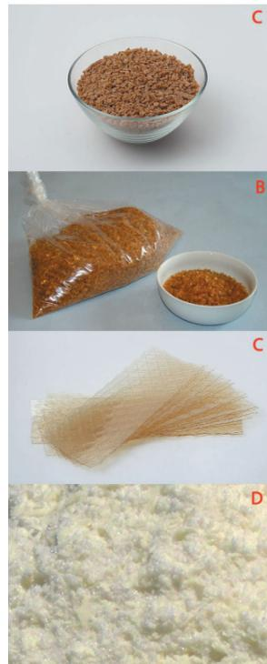
**Foto 4.** L'aspetto di quattro colle di origine animale: A) colla di coniglio, B) colla di pelle, detta anche garavella, C) colla di pesce, D) colla di caseina.
