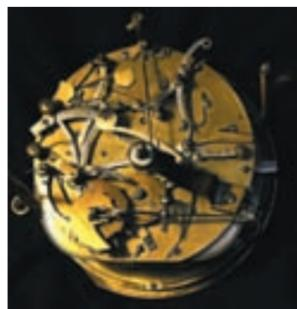
Foto 4. Particolare del movimento. Notiamo la forchetta che mossa dalla leva solleva e sostituisce la chiocciola anteriore con quella posteriore, per passare dalla suoneria in dodici a quella in sei. Notiamo anche che le platine sono tagliate, caratteristica che generalmente data l'orologio anteriormente al 1805.
