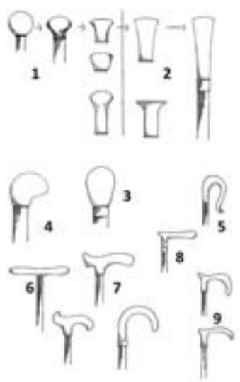
Foto 1. Tipologie di impugnature: 1 a pomolo, 2 a pennacchio, 3-4 ad uovo, 5 a gancio, 6 a T, 7 a tau, 8 laterale, 9 a becco di corvo.
