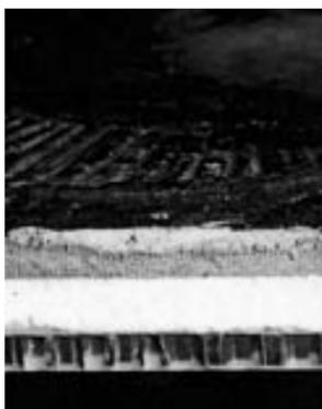
Foto 3. Strato superiore: intonaco con tela e caseina. Strato intermedio: di sacrificio. Strato inferiore: nuovo supporto in vetroresina a nido d'ape.
