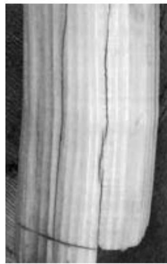
Foto 8. Sezione foto 6. Notiamo le crepe longitudinali tipiche dell'invecchiamento.
