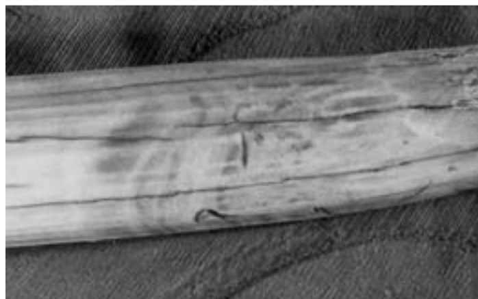
Foto 7. Sezione foto 6. Notiamo le macchie dovute all'invecchiamento.
